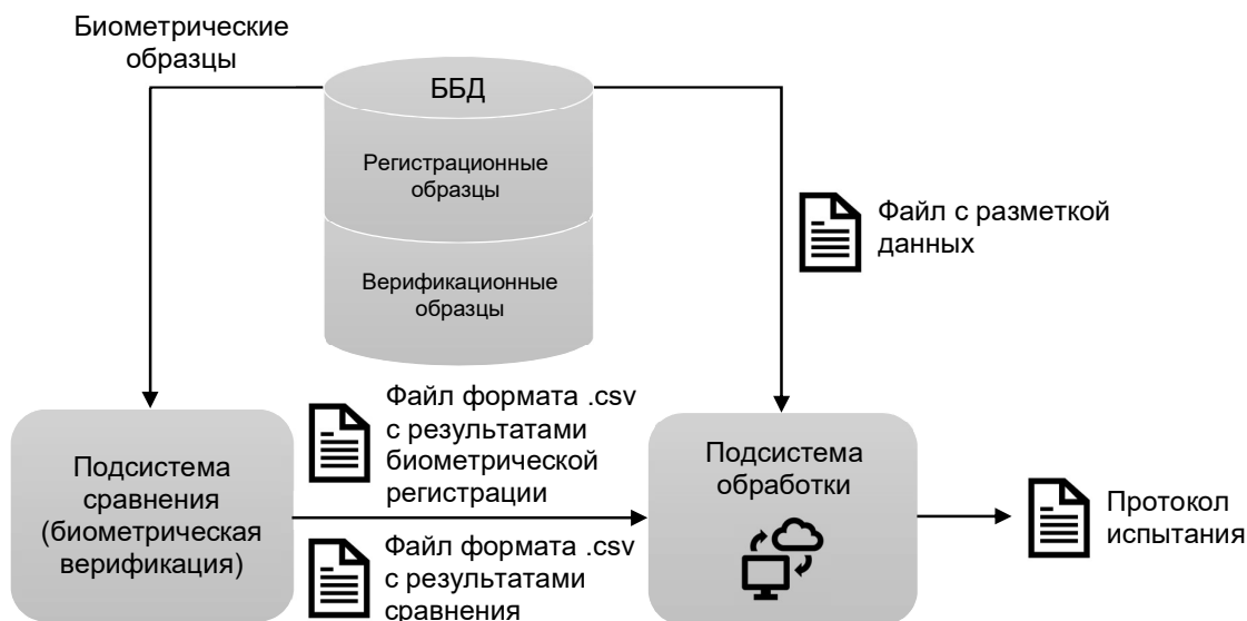
Рисунок 1 – Схема испытательного стенда для проведения технологических испытаний подсистем сравнения (биометрическая верификация)
