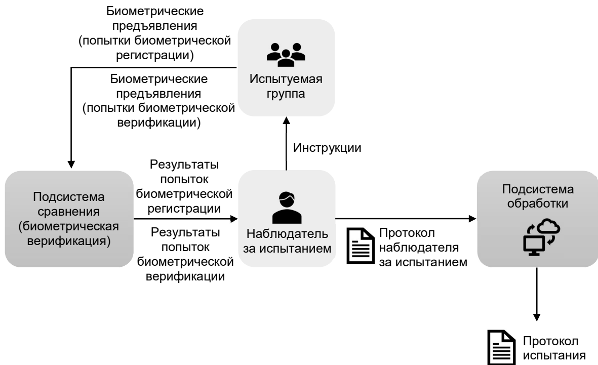
Рисунок 2 – Схема испытательного стенда для проведения сценарных испытаний подсистем сравнения (биометрическая верификация)
