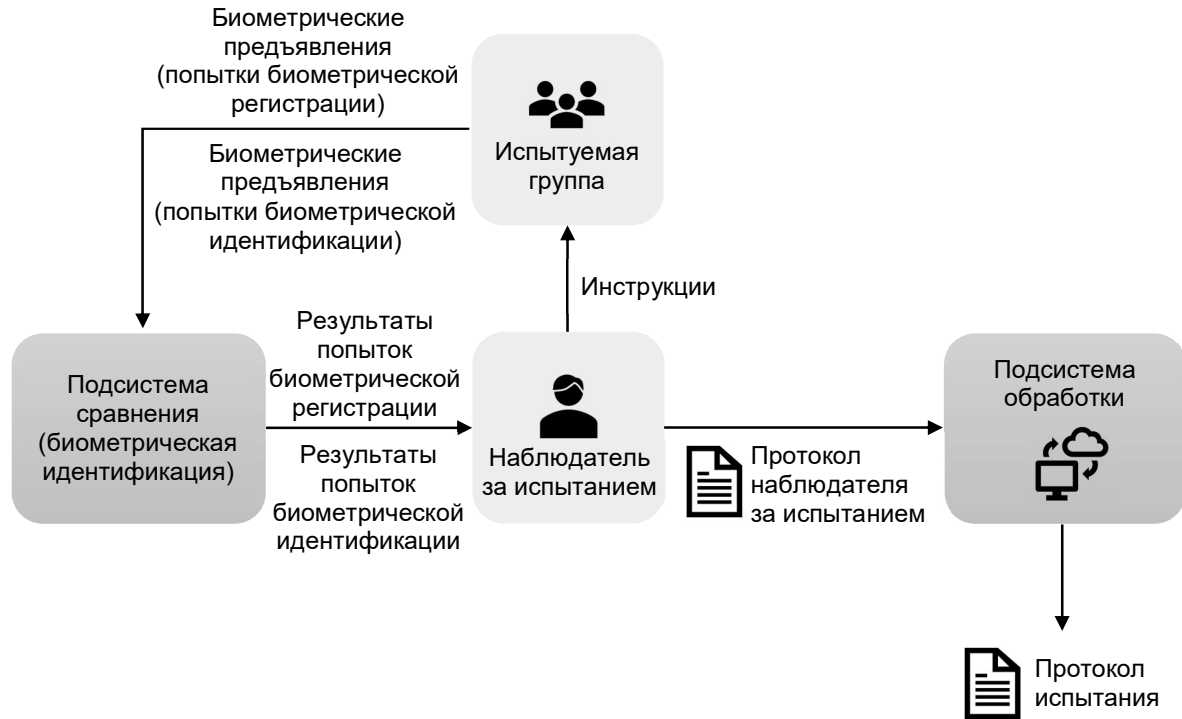
Рисунок 2 – Схема испытательного стенда для проведения сценарных испытаний подсистем сравнения (биометрическая идентификация)
