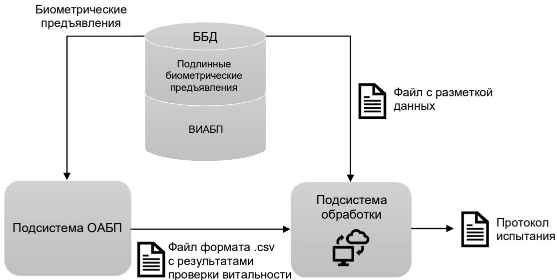
Рисунок 1 – Схема испытательного стенда для проведения технологических испытаний подсистем ОАБП
