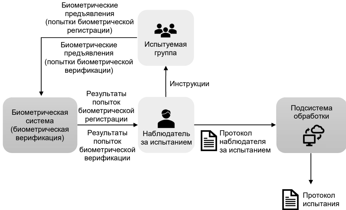
Рисунок 2 – Схема испытательного стенда для проведения сценарных испытаний биометрических систем (биометрическая верификация)
