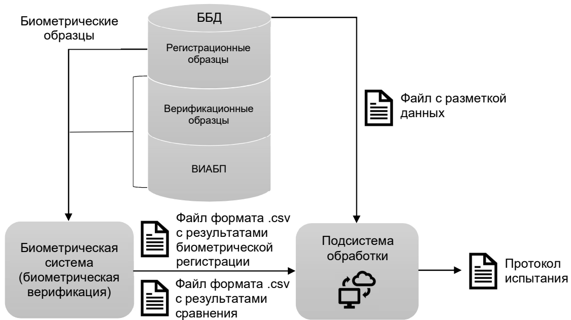
Рисунок 1 – Схема испытательного стенда для проведения технологических испытаний биометрических систем (биометрическая верификация)
